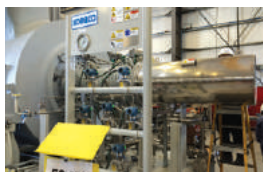
運転に必要な補助装置と共にパッケージ化された同社の圧縮機。顧客に合わせたテラメイド品だ。
