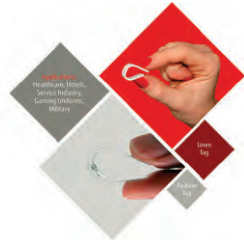
衣類やリネンに埋め込まれている、何度も洗えてフレキシブルなRFID。
