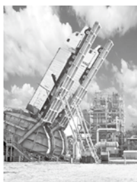
トレーラーを立てて、廃材などのバイオマス燃料を積み出しているところ
